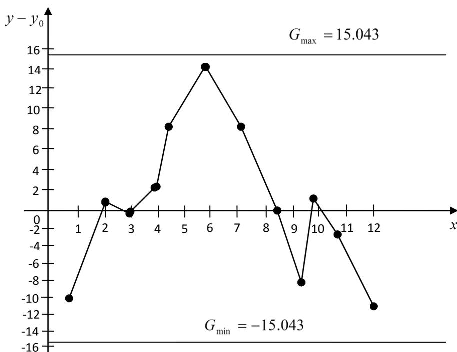
Из этой диаграммы следует, что нет точки вне контрольной зоны. Следовательно, прогнозирующая функция (6) может быть использована для характеристики уровня спроса. Несмотря на это, характер расположения точек внутри зоны контролируемости вызывает беспокойство, ибо точки с номерами 1, 6, 12 находятся вблизи контрольной границы.
